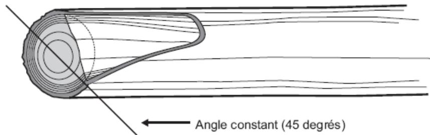
ii. Angle constant affecté par l'éclat, changer l'angle jusqu'au diamètre complet le plus proche
