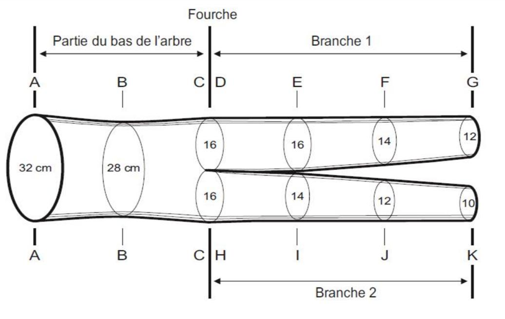
Dans la figure 59, le diamètre au fin bout de la partie du bas de l'arbre, en « C », est de 22 cm, résultat de la combinaison des diamètres de 16 cm (D et H) qu'on a mesuré à la fourche. La découpe « D » devient le gros bout de la branche 1, comme celle en H devient celle de la branche 2.
