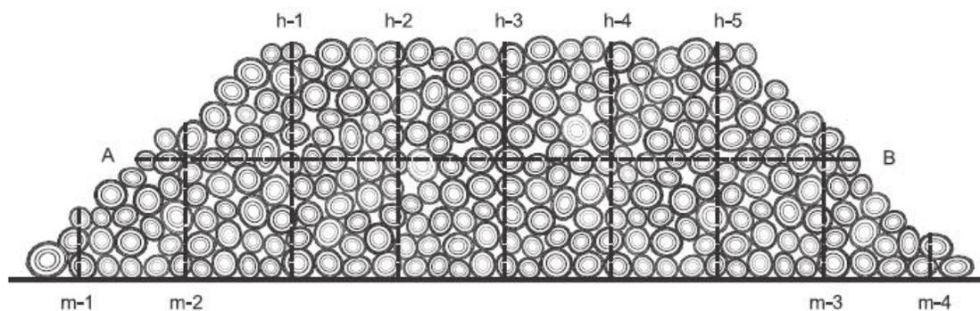
Le mesureur prend la longueur moyenne AB et la hauteur aux points h-1, h-2, h-3, h-4 et h-5. Il doit éviter de la mesurer aux points m-1, m-2, m-3 et m-4.
