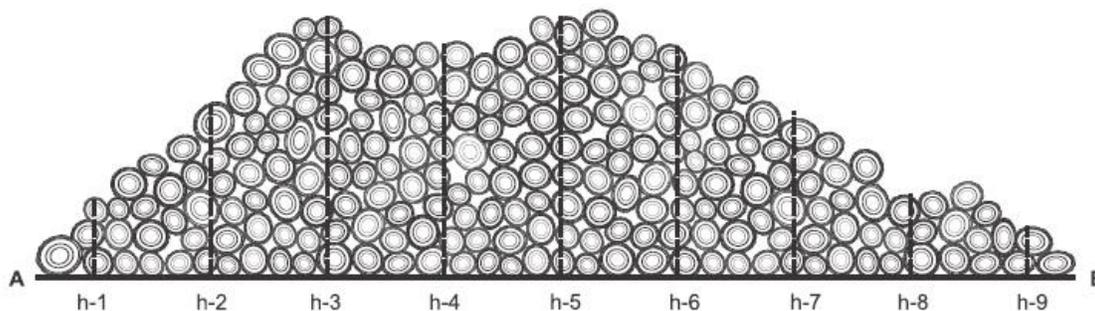
Le mesureur prend la longueur à la base de la pile, au niveau du sol, entre les points A et B et la hauteur aux points h-1, h-2, h-3, etc. On peut aussi avoir recours à cette méthode pour mesurer une longue pile régulière, sans supports latéraux.
