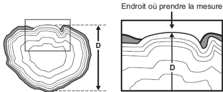
Figure 42 – Mesurage d'une découpe avec inclusion d'écorce
