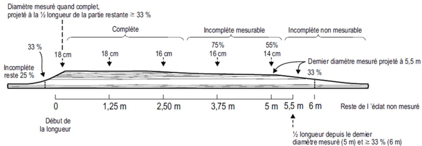
**Figure 64 – Longueur marchande d’une grume avec une partie non facturable**
