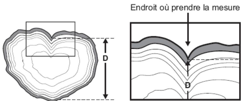
Figure 43 – Mesurage d'une découpe avec fente ouverte
